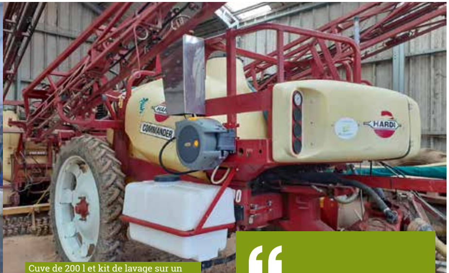
Cuve de 200 l et kit de lavage sur un pulvérisateur traîné Hardi, 2004, 2800 l.
