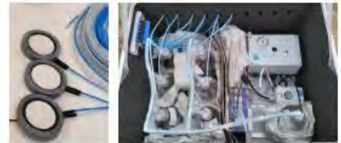
Plaques de prélèvement de l'eau (EcoTech) + boîte isotherme
