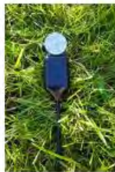
Sondes de potentiel hydrique (Teros 21) à 30, 60 et 90 cm
